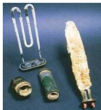
Resistenze con deposito calcareo
